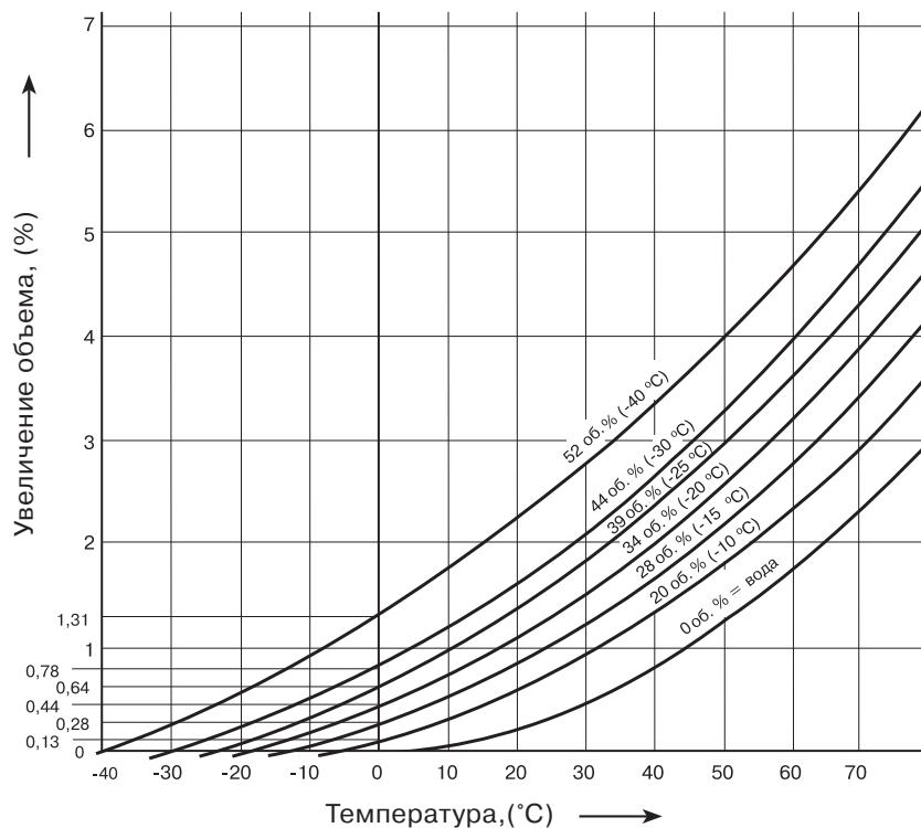
**Рисунок № 2. Диаграмма температурного расширения воды в % при ее нагреве (охлаждении) от 10 °C до средней температуры системы**
