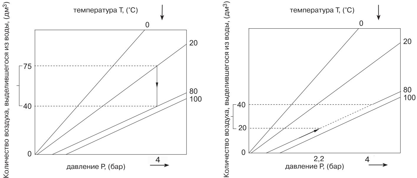
При повышении температуры воды при постоянном давлении в системе или при понижении давления при постоянной температуре происходит высвобождение растворенного в воде воздуха. Данные диаграммы, иллюстрирующие закон Генри, позволяют определить количество выделившегося из воды воздуха (ранее растворенного).
