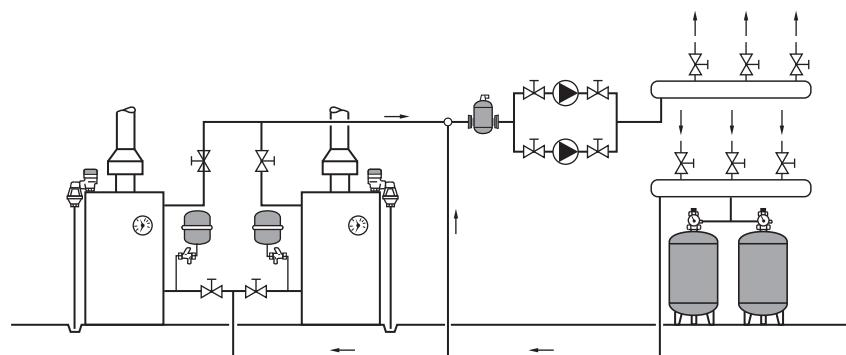
**Типовой пример установки расширительных баков Flexcon в системах охлаждения**
