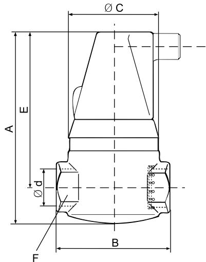
**Размеры сепаратора воздуха Flamcovent в стальном исполнении****Таблица № 36. Основные размеры сепаратора воздуха Flamcovent в стальном исполнении**
