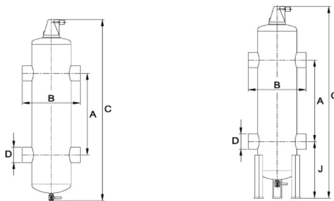
**Параметры гидравлической стрелки Flexbalance PLUS**
