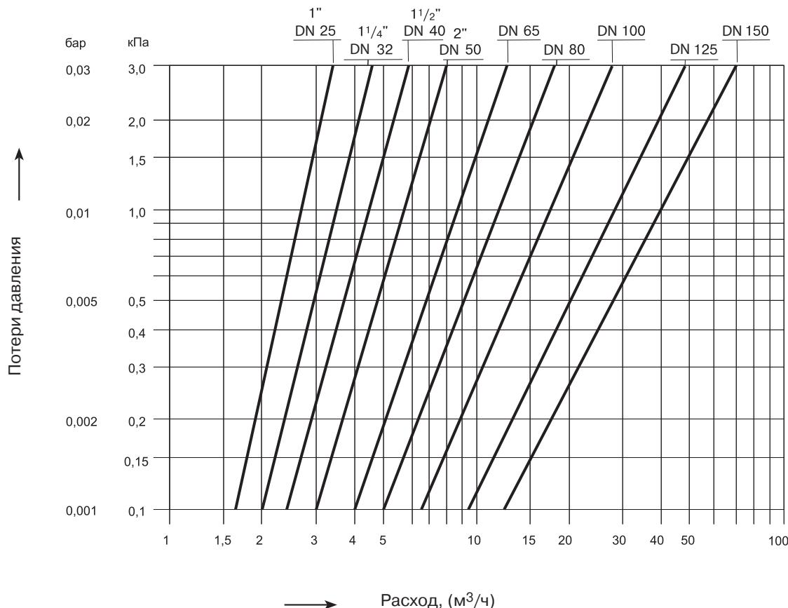
**Основные размеры и характеристики центробежных сепараторов воздуха Flexair**
