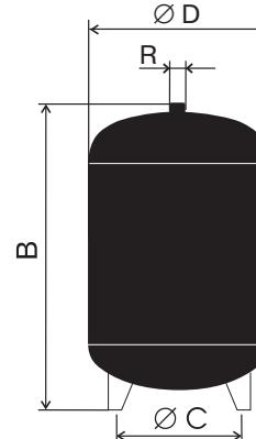
Таблица № 8. Параметры расширительного бака Flexcon CE (10 бар)
