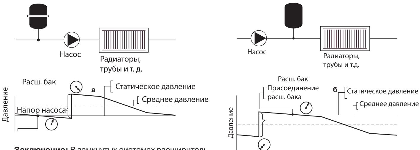
**Заключение:** В замкнутых системах расширительный бак Flexcon следует устанавливать перед всасывающим патрубком насоса. Различия в уровнях установки расширительного бака Flexcon и предохранительного клапана по возможности должны быть сведены к минимуму.
