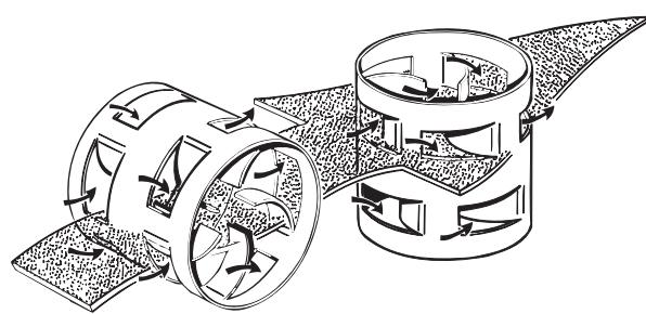
**Таблица № 34. Типоразмеры PALL-кольец, используемых в сепараторах воздуха Flamcovent**
