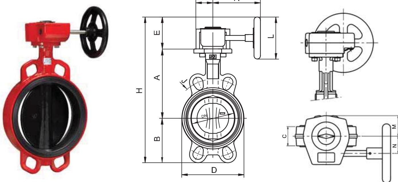
**Основные параметры дискового поворотного затвора ГРАНВЭЛ® межфланцевого с редуктором**
