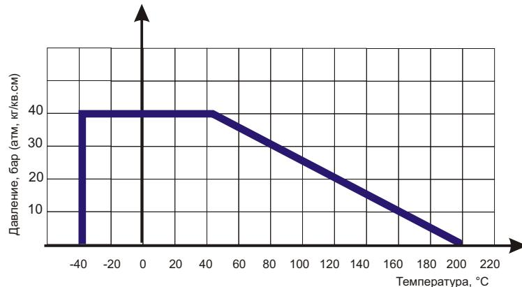
Диаграмма определяет рабочую область для шарового крана фланцевого ABRA-BV11 в координатах Давление (в барах приборного) / Температура (° С).
