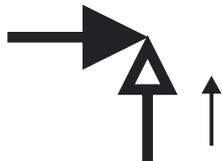
Справочно: Условное графическое обозначение клапана обратного **углового** на чертежах и схемах, стрелка указывает направление потока.
